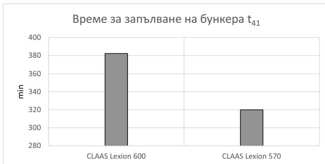
Фиг. 4. Сравнителен анализ на времената за запълване на бункера
